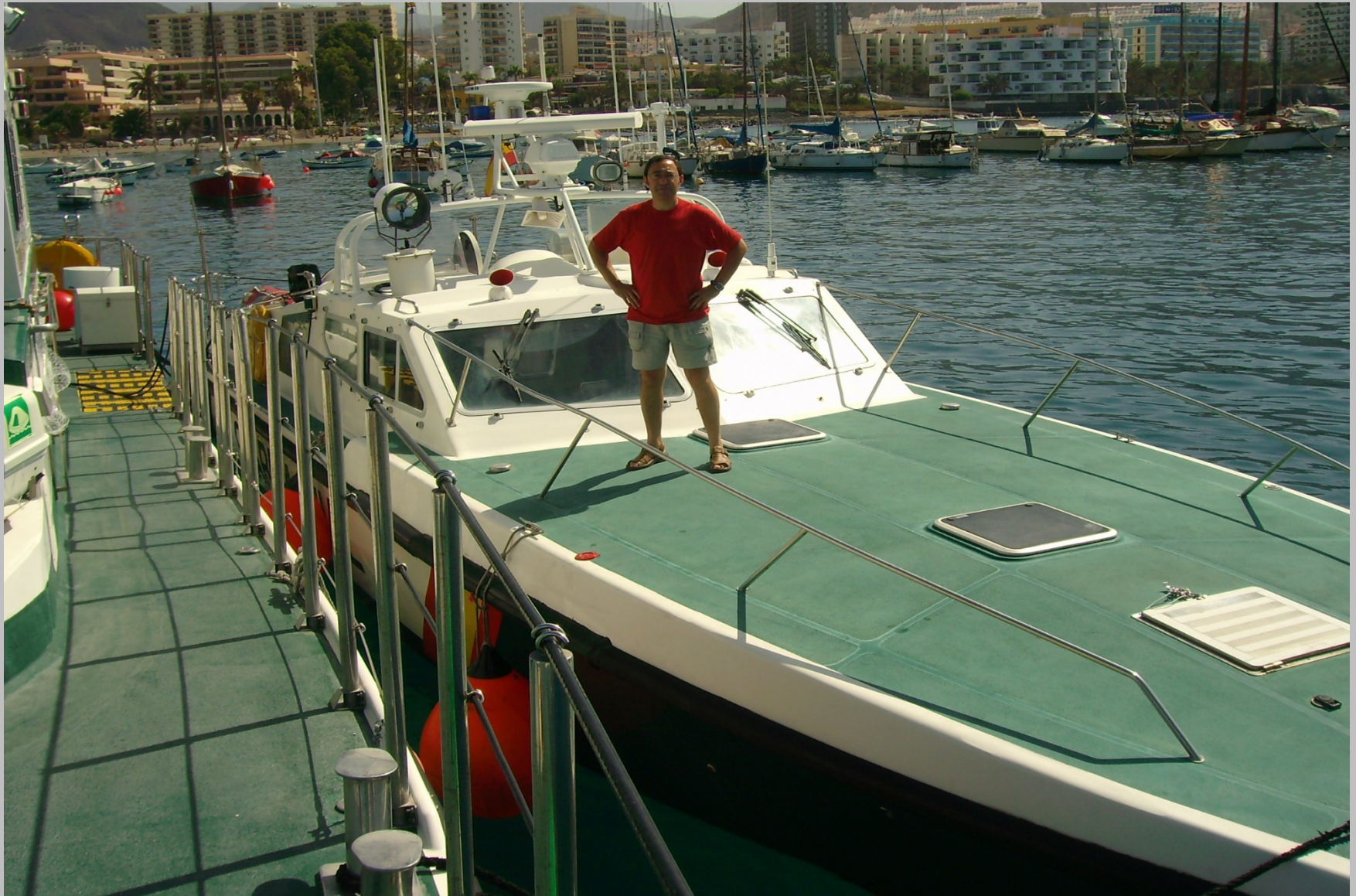
Lancha auxiliar de intervención rápida Rio Gallo . Adjunta a la patrullera Pico del Teide, puede desarrollar 50 nudos. Tiempo de intervención 20 minutos.
